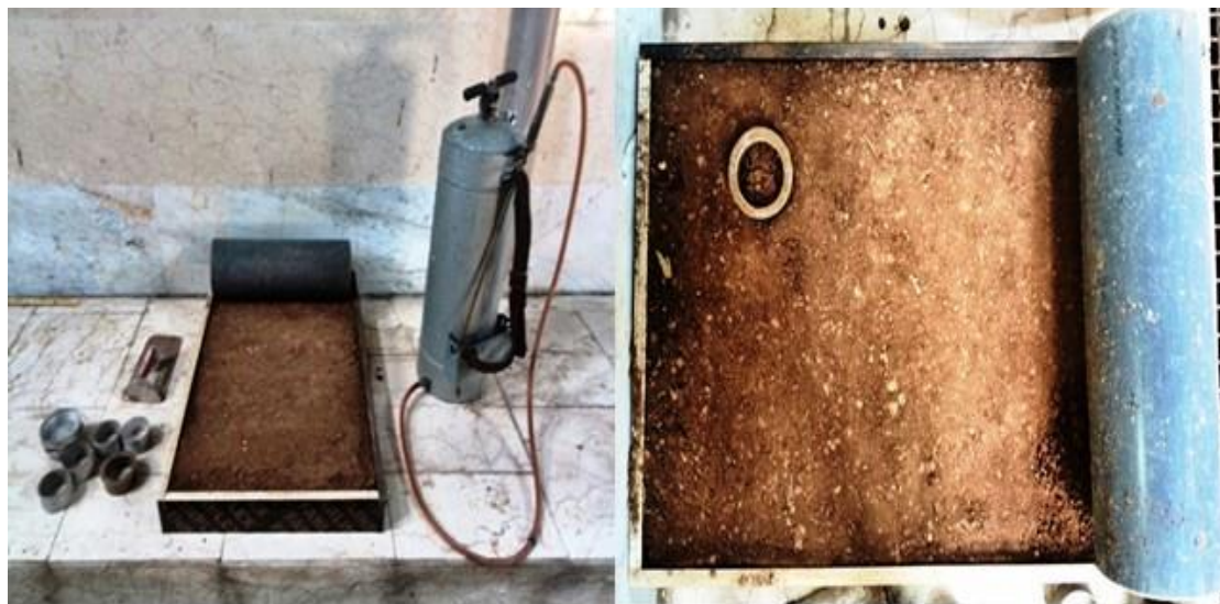
شکل ۲-۲- شبیه‌سازی پلات برای رسیدن به تعداد بهینه رفت و برگشت غلطک
