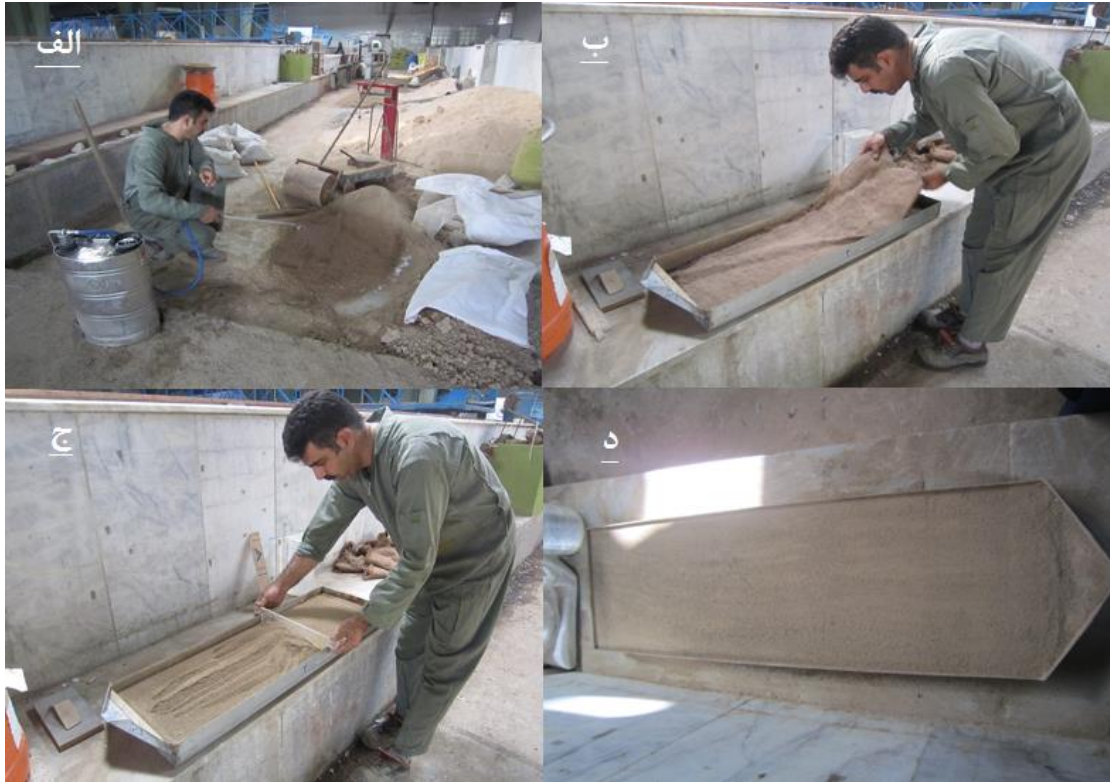
شکل ۳-۲- تصاویری از آماده‌سازی خاک و پلات - الف: نم‌دار کردن خاک - ب: قرار دادن گونی کنفی - ج: تصحیح پستی و بلندی سطح خاک و د: پلات آماده‌شده برای انجام آزمایش
