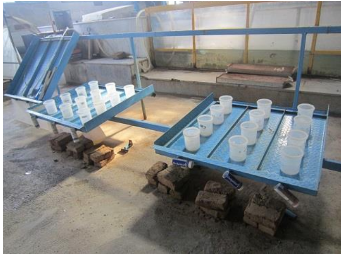
شکل ۱-۲- چیدمان ظروف روی سطح پلات برای اندازه‌گیری یکنواختی بارش
