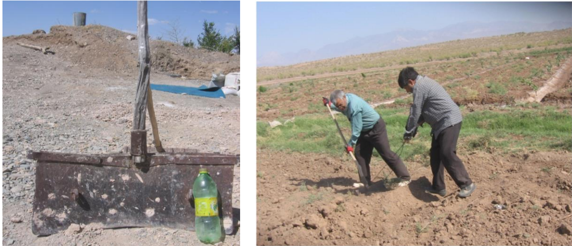
شکل ۳- نمونه پنجه دستی و نحوه کارکردن با آن برای کشیدن دیواره بند، کشیدن نهر و اصلاح و ترمیم آن‌ها در بندسارها
