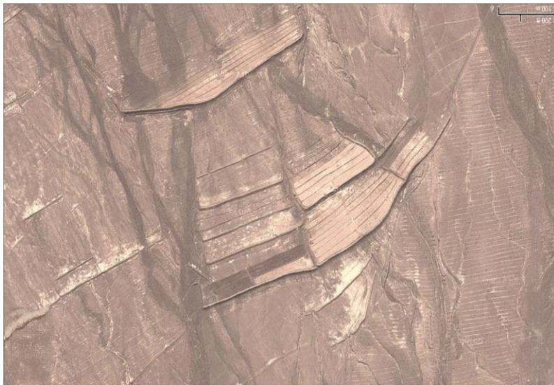
شکل ۱۳- نمونه یک بش‌بند که مستقیماً بر روی مسیل ساخته شده و پس از تله‌اندازی رسوبات درشت دانه
