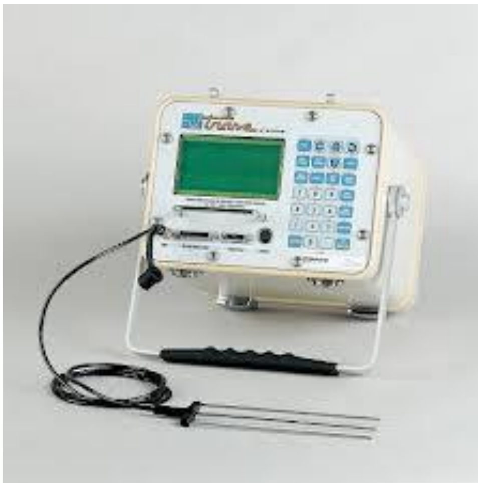
شکل ۲-۱۲- نمایش شماتیک دستگاه رطوبت سنج TDR
