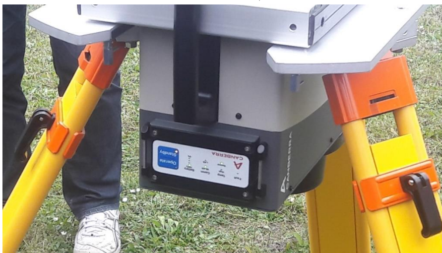
شکل ۱۹: دستگاه گاما اسپکترومتر ثابت در محل پرتودهی رادیونوکلئیدهای ریزشی
