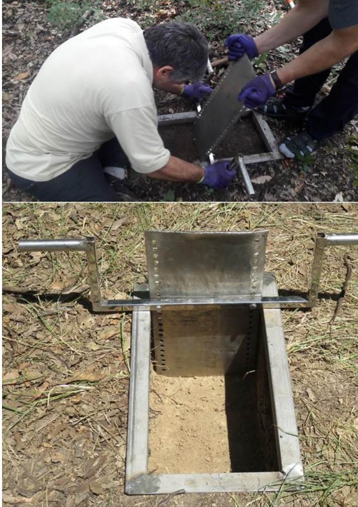
شکل ۶: نمونه‌برداری از محل مرجع توسط دستگاه صفحه لایه بردار، استان مازندران
