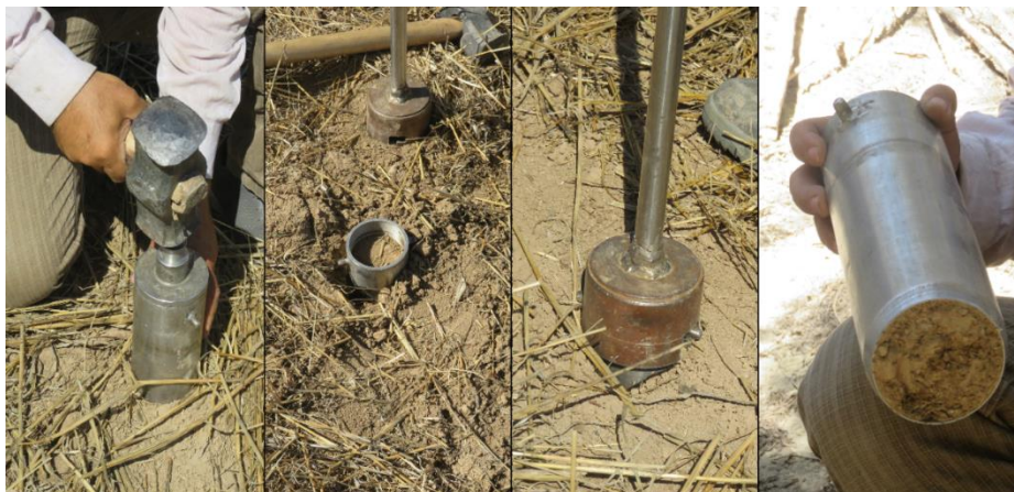
شکل ۷: نمونه‌برداری با استفاده از دستگاه مغزه‌گیر خاک، اراضی دیم استان گلستان
