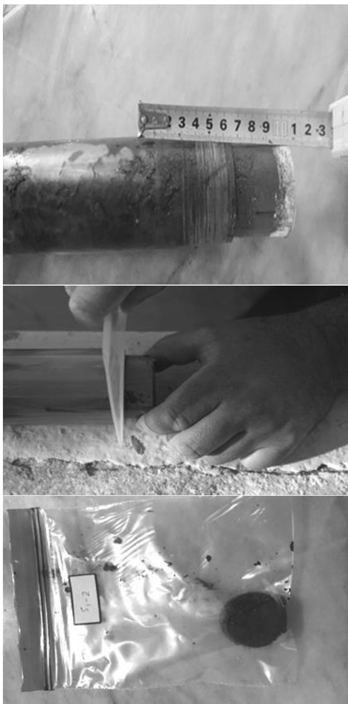
شکل ۱۴: برش و استحصال نمونه‌ها از مغزه رسوبی
