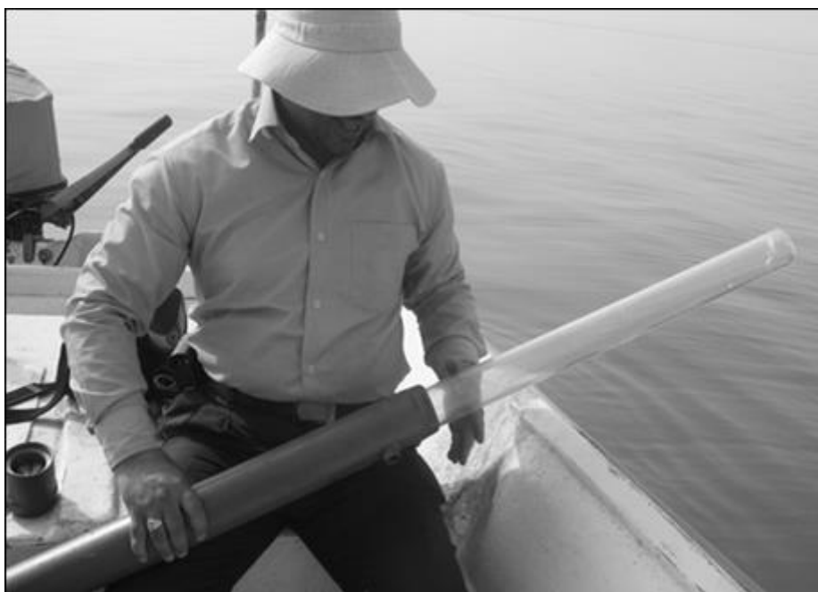
شکل ۱۱: آماده سازی مغزه گیر رسوبات بستر با لوله شفاف داخلی
