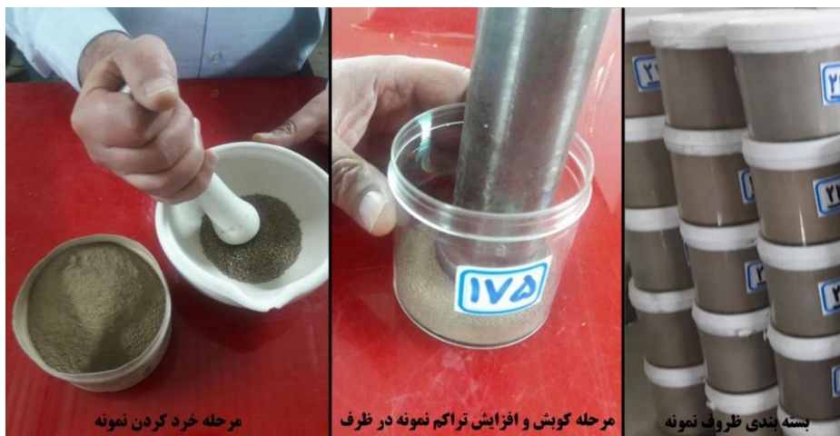
شکل ۱۰: مراحل آماده سازی نمونه خاک، آزمایشگاه مکانیک خاک پژوهشکده حفاظت خاک و آبخیزداری کشور
