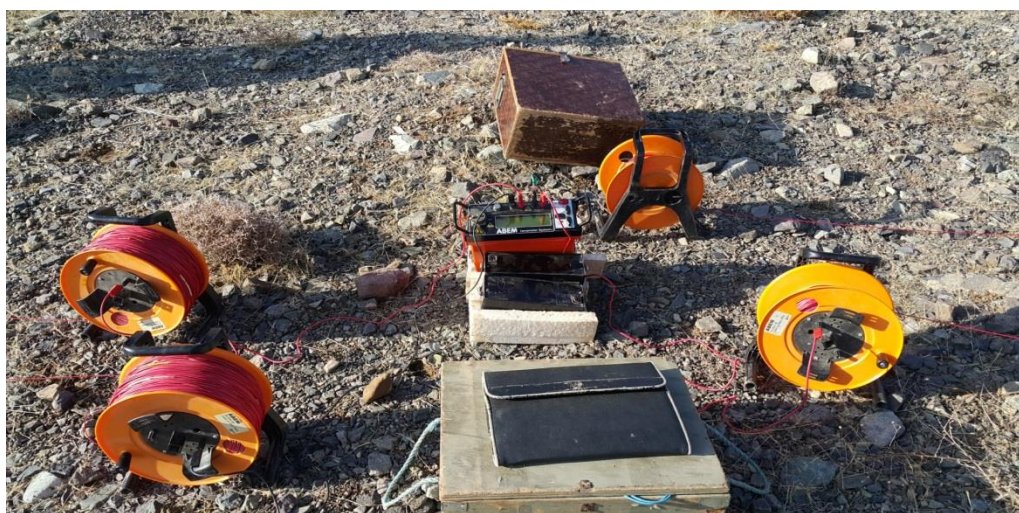
شکل ۶: دستگاه SAS 4000 همراه با قرقره‌های جریان و پتانسیل
