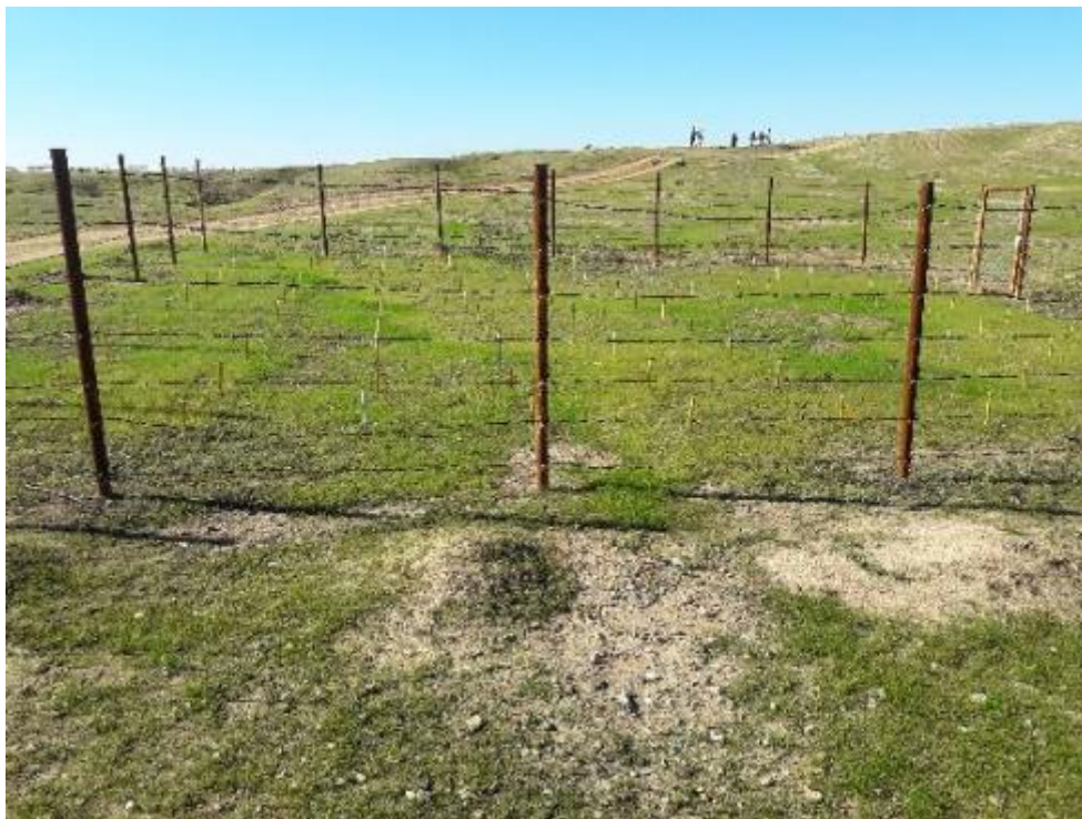
شکل ۱۲- میدان پین برای اندازه‌گیری فرسایش سطحی حوضه نمونه (آذرماه ۱۳۹۹)
