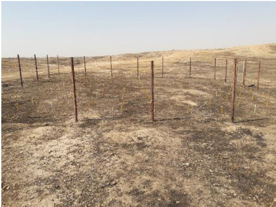
شکل ۱۱- میدان پین محصور شده برای اندازه‌گیری فرسایش سطحی - حوضه نمونه
