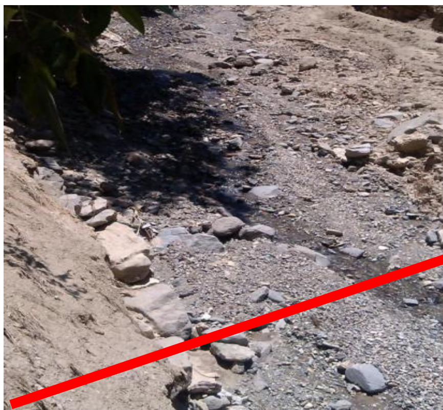
شکل ۹- مقطع برآورد دبی اوج سیل ۲۸ تیر ماه ۱۳۹۴ براساس داغاب آن در بدو ورود به باغات و روستای
