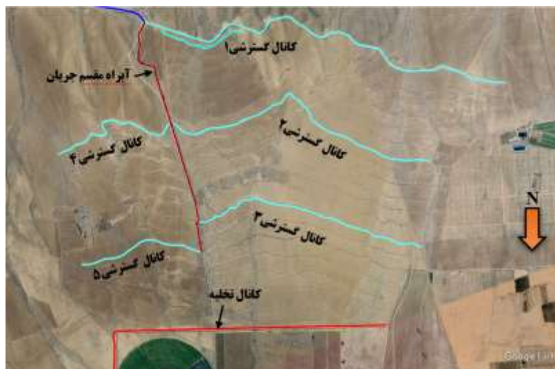
شکل ۲۱- آبراه طبیعی (مقسم)، کانال گسترشی و کانال تخلیه جریان
