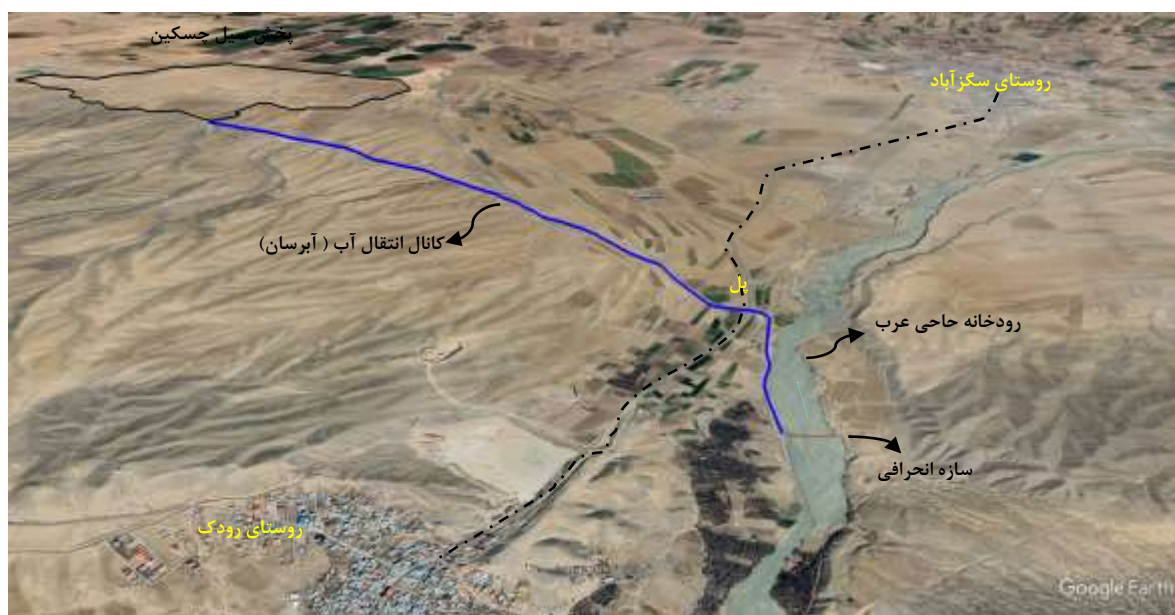
شکل ۲- اجزاء اصلی سامانه پخش سیلاب چسکین
