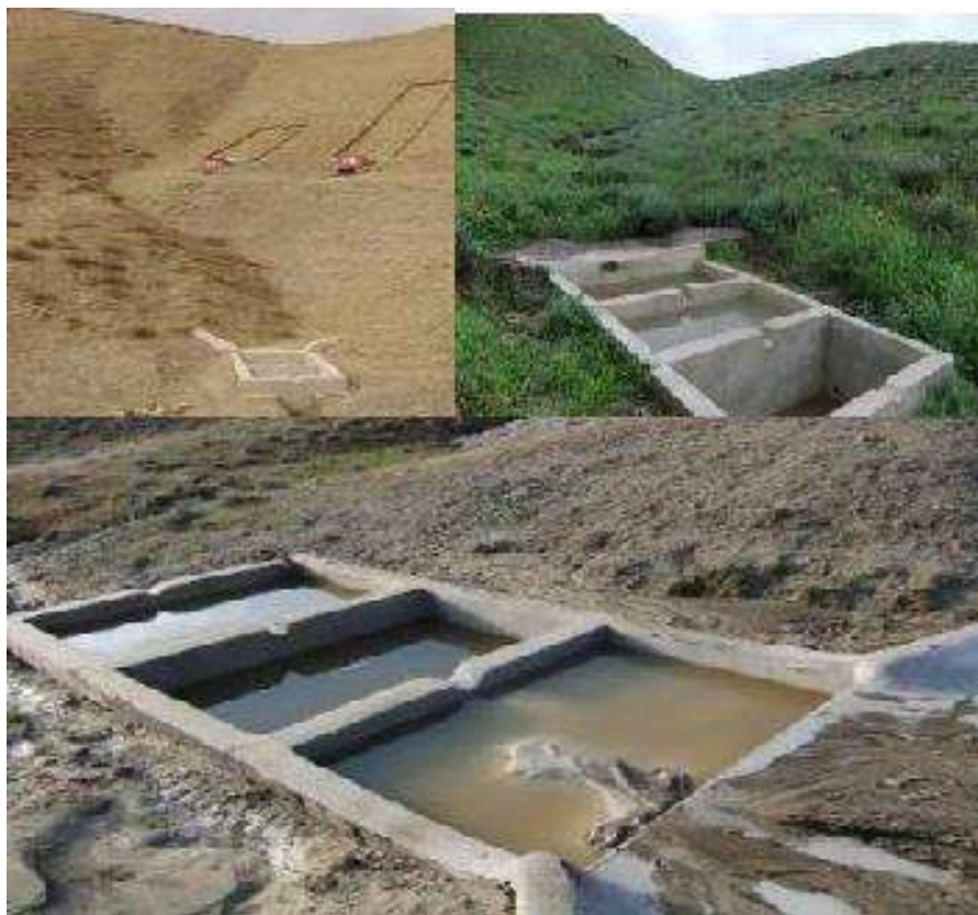
شکل ۳- نمونه‌هایی از مخازن جمع‌آوری رسوب در مقیاس آبخیز کوچک در حوزه آبخیز پژوهشی سنگانه،
