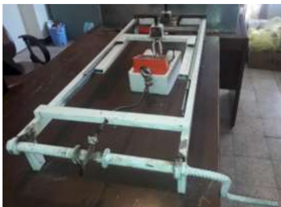
شکل ۳-۱۴- دو نوع دستگاه اندازه‌گیری مقاومت کششی ریشه
