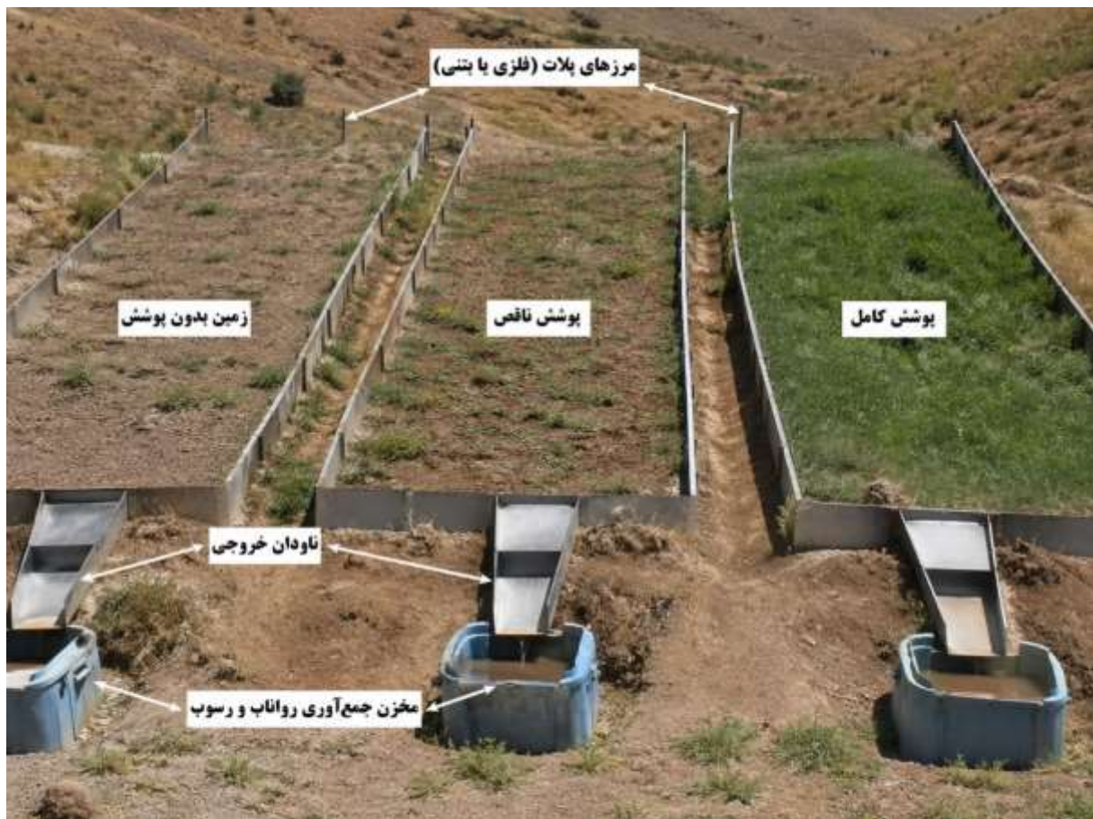
شکل ۳-۳- نمونه‌ای از پلات‌های اندازه‌گیری فرسایش با پوشش گیاهی مختلف
