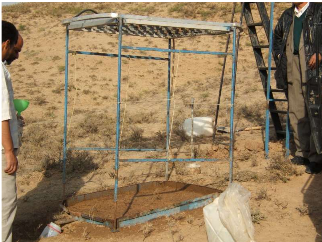
شکل ۳-۴- اندازه‌گیری رواناب و رسوب جمع‌آوری شده با استفاده از شبیه‌ساز باران یک مترمربعی
